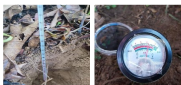
Gambar 2. Pengukuran parameter fisikokimia lingkungan: pengukuran suhu (kiri), pengukuran pH dan kelembaban tanah (kanan).
